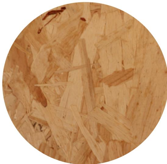
Figura 9: Placas de Partículas Orientadas – OSB.
